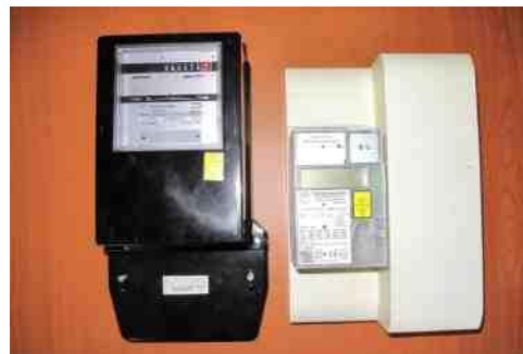
Links der bisherige elektromechanische Ferraris-Zähler, rechts ein digitaler Zähler (moderne Messeinrichtung)
